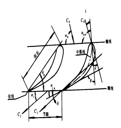
$a_y$ —安装角; $a_{0n}$ —叶片进口角; $a_{1n}$ —叶片出口角; $a_0$ —进汽角; $a_1$ —出汽角;e—汽流折转角;i—冲角; $\delta$ —落后角; $C_0$ —进汽速度; $C_1$ —出汽速度; $\theta$ —叶型折转角
