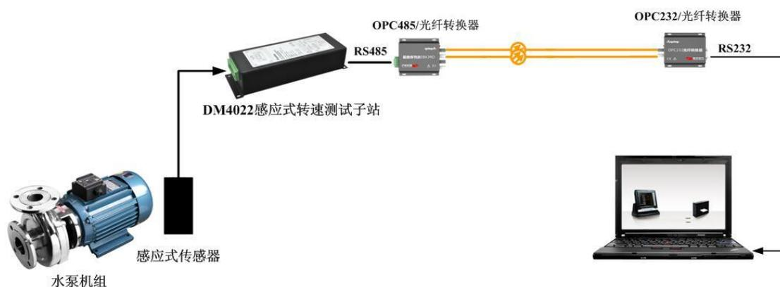
DM4022 感应式转速计在水泵机组转速测试用的应用
